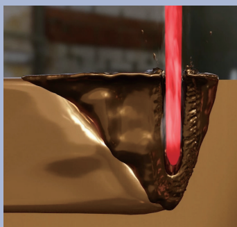
IRレーザー キーホール溶接 高輝度が必要 スパッタが発生
