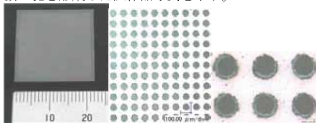
図 4. “Glass-ribbon”孔あけ試作品 サイズ：20×20mm、厚み：15 \mu\text{m} 厚 孔径：50 \mu\text{m} 、孔ピッチ：100 \mu\text{m}
