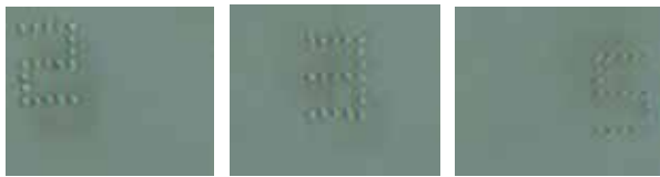
(a)-5 mm (b) 焦点面 (c) +5 mm 図 7 3次元多点分岐による加工痕
