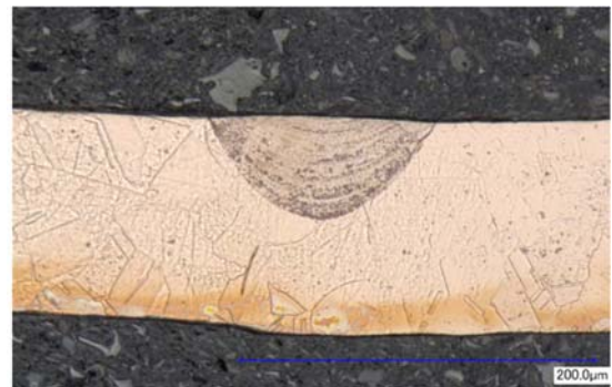
Fig. 2 1.3 \times 10^6 \text{ W/cm}^2 青色半導体レーザーを用いたときの溶接ビード断面
