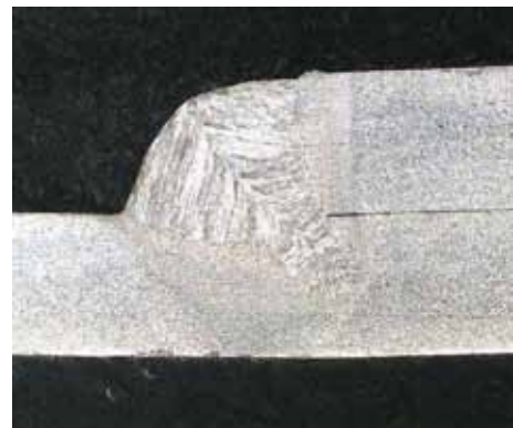
図 8. 溶接ビード断面写真
