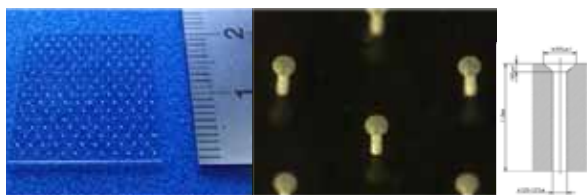
図 2.MHA 試作品（左：全体、右：拡大） （ガラス材料：石英ガラス 1mm 厚）
