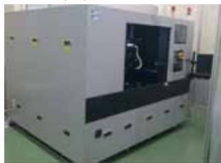
図 1. 超短パルスレーザー加工装置 本装置の主な特徴は、以下の 3 点。
